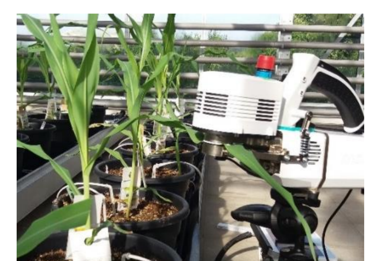
Abb. 3 Messung der WNE mit einem Gaswechsellmessgerät (LICOR-6800)
