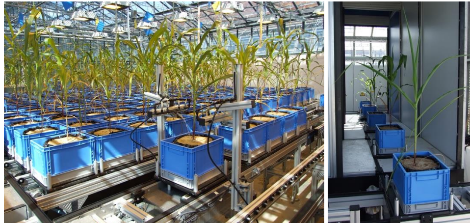
Abb. 11: Topfversuch zur differentiellen AM-Antwort von 16 Mais-Genotypen in der automatisierten LemnaTec Anlage der LfL. Gewächshaus und Bewässerungsanlage (links), automatisierte Bildaufnahme-Kammern (rechts).
